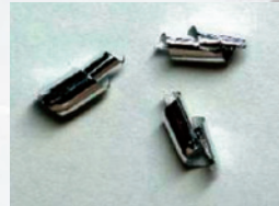
DLCコートチップの切りくず Chip of DLC Coated insert
