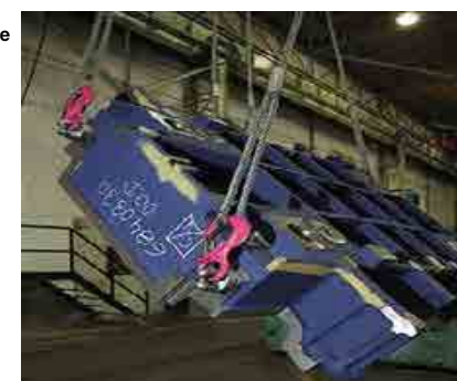
ダブルボールベアリング採用 負荷時でも360°スムーズに回転します
