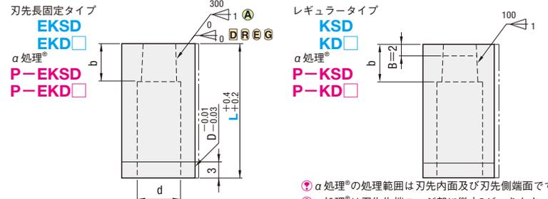
α処理®の処理範囲は刃先内面及び刃先側端面です。
