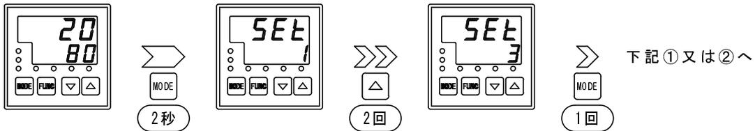
① 現在温度 (PV) が設定温度 (SV) より +20°C 高い時にアラームを動作させる場合
