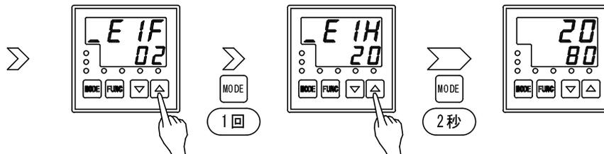
② 現在温度 (PV) が 100°C の時にアラームを動作させる場合
