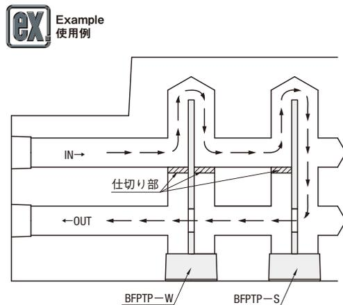
冷却用水穴(横穴)の先にエジェクタピンや傾斜スライドがあり、横穴が貫通できない場合、縦方向の水穴内を仕切り、バッフル板途中に穴を設けることで、IN-OUTを同一面上に設置する構造がとれます。
