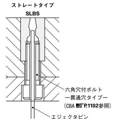
型板厚にかかわらず使用できます。特に、板厚が厚い場合に最適です。取り付けには貫通穴があいている六角穴付ボルト(CBA)をエジェクタピンの径に合わせてご使用ください。
