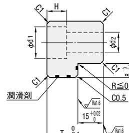
材質 高力黄銅鑄物4種 (CAC304) (旧JIS: HBsC4) 特殊固体潤滑剤埋設
