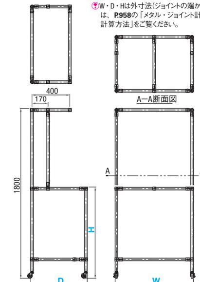
W・D・Hは外寸法(ジョイントの端から端までの距離)となります。詳しくは、P958の「メタル・ジョイント計算例」・P925の「パイプ寸法の計算方法」をご覧ください。
