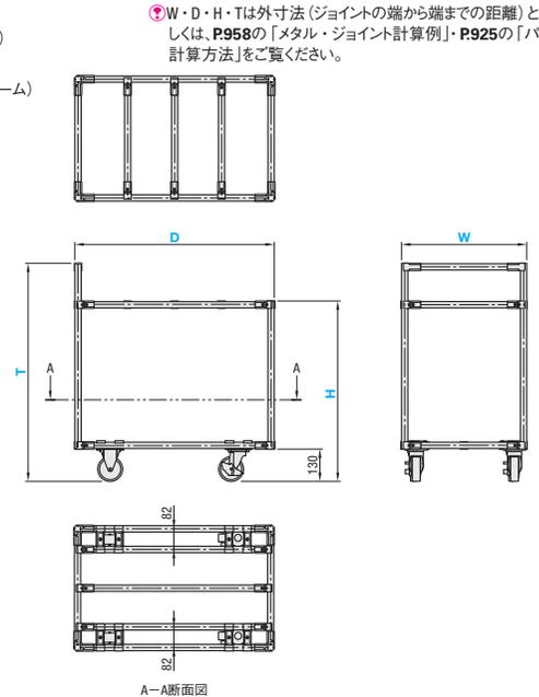
W・D・H・Tは外寸法(ジョイントの端から端までの距離)となります。詳しくは、P958の「メタル・ジョイント計算例」・P925の「パイプ寸法の計算方法」をご覧ください。
