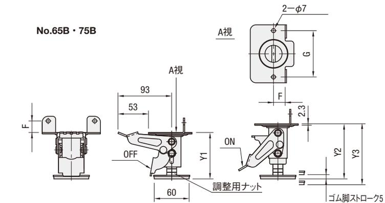
調整用ナットを廻すことでパッド部が可変し、床面からの距離を調整できます。
