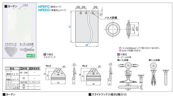
■カーテン 型式 高さ(H) 指定100mm単位 使用シート P.840 No. Туре HPEFT0.2 **HPEFC** HPEDT0.2
