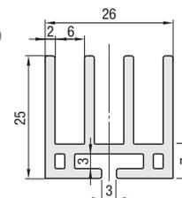
①スライドレールはスライドレール用コネクタを使用してアルミフレームと接続します。 ②材質 ABS樹脂(ライトグレー)
