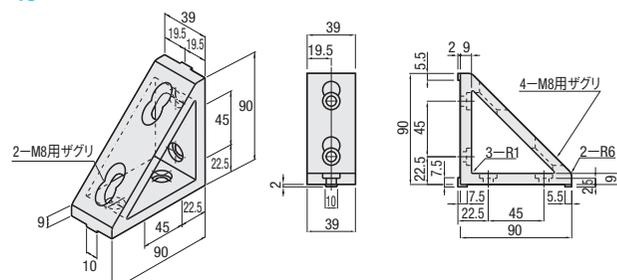
RoHS10 M材質 A6N01SS-T S表面処理 アルマイト処理
