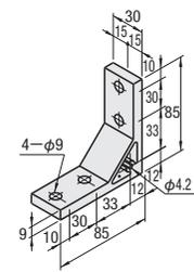
RoHS10 M材質 A6N01SS-T5 S表面処理 アルマイト処理
