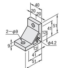
M材質 A6N01SS-T5 S表面処理 アルマイト処理
