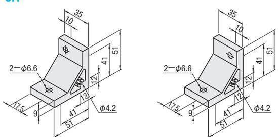
M材質 A6N01SS-T5 S表面処理 アルマイト処理
