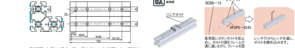
断面がL型の場合、低い段を奥にし左端面からの距離を選択します。
