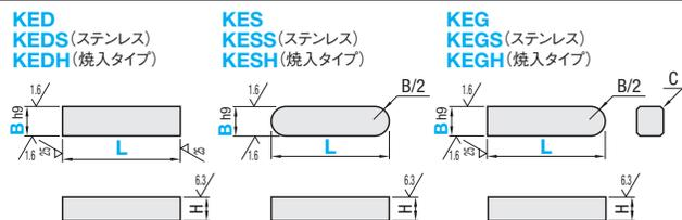
S45Cのご希望寸法が固定寸選択タイプにない場合はフリー指定タイプ(P.286)をご利用ください。焼入タイプは識別の為、刻印があります。B寸・H寸はJIS B 1301-1996(新JIS規格)に準ずる。
