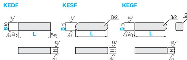
固定寸選択タイプ(P.285)にない場合にフリー指定タイプをご利用ください。B寸・H寸はJIS B 1301-1996(新JIS規格)に準ずる。
