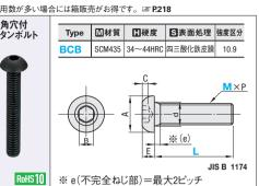
HEXAGON SOCKET BUTTON HEAD CAP SCREWS -STEEL-
