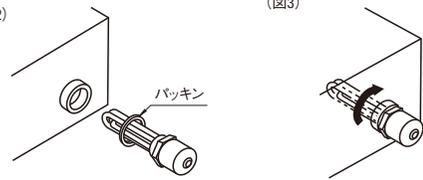
※締め付け後は、空気漏れがないことを確認してください。
