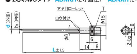
●バープ継手タイプ ABNZT (L寸固定) ABNZTL (L寸指定)
