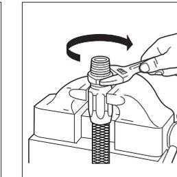
④ニップルを時計の針と同じ方向に廻しながらソケットにねじ込み、ニップルの6角とソケットのスキマが0.2~1.0mmになるようにします。
