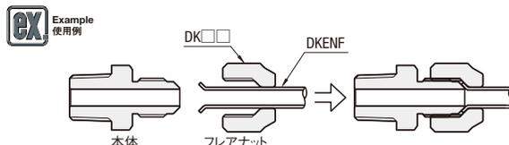
・先端フレアタイプの銅管にフレアナットをはめこんでください。本体面と銅管面を確実に当てる。フレアナットを手締し、スパンおよびモンキーレンチ等できっちり締めこんでください。
