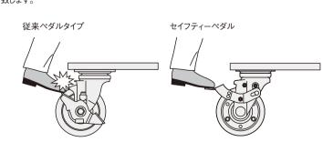
ペダルを踏み込むと旋回と車輪が同時にストップ、振動による横ズレ防止効果があります。
