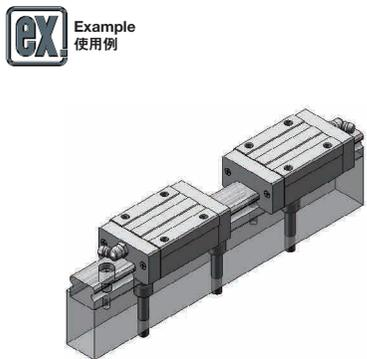
適応リニアガイド P.561~P.562 ミニチュアリニアガイドL寸定寸タイプに適用
