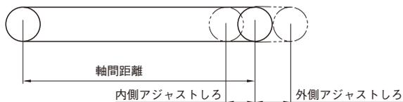
表7-a 内側アジャストしろ(取付代) ベルト種類 内側アジャストしろ
