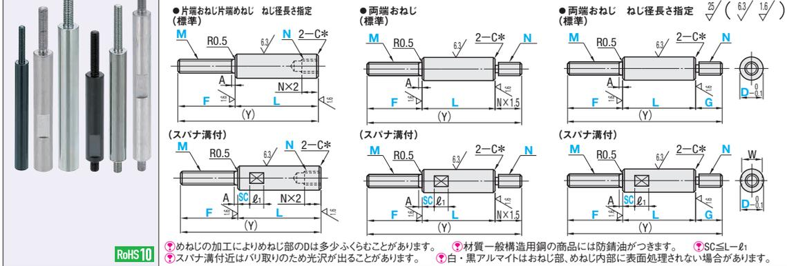
ねじの加工によりめねじ部のDは多少ふくらむことがあります。材質一般構造用鋼の商品には防錆油が付きま...
