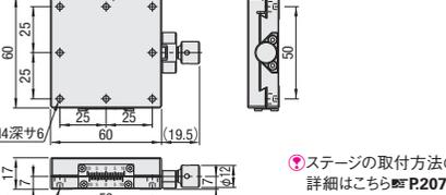
◎詳細寸法はCADデータをご確認ください。 ※ステージ形状の制約のため、深さが短くなります。 ■材 質: アルミ合金 ■S 表面処理: 黒アルマイト
