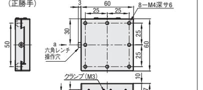
◎カタログ値以上にストロークさせると、プレートが外れることがあります。 ※形状制約により、深さが短くなっています。 ■材 質: アルミ合金 ■S 表面処理: 黒アルマイト
