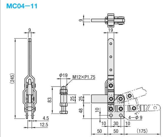
■ 下面押さえ・ハンドル立型 先端ボルト溶接タイプ (ストレートベース)
