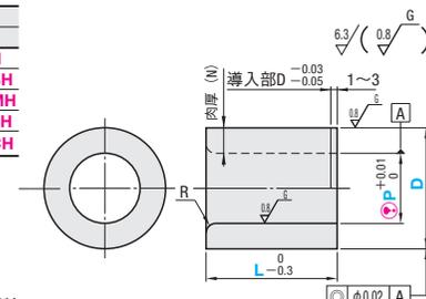
●p6タイプはm6タイプよりも、内径収縮が大きい為、穴加工の際はご注意ください。(P.1802圧入後の内径変化参照)
