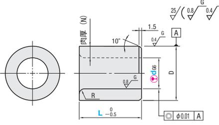
●p6タイプはm6タイプよりも、内径収縮が大きい為、穴加工の際はご注意ください。(P.1802圧入後の内径変化参照)
