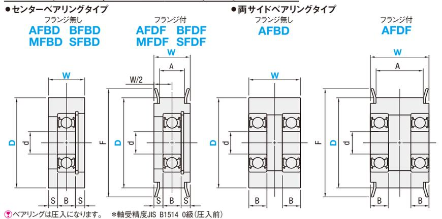
ベアリングは圧入になります。\*軸受精度JIS B1514 0級(圧入前)
