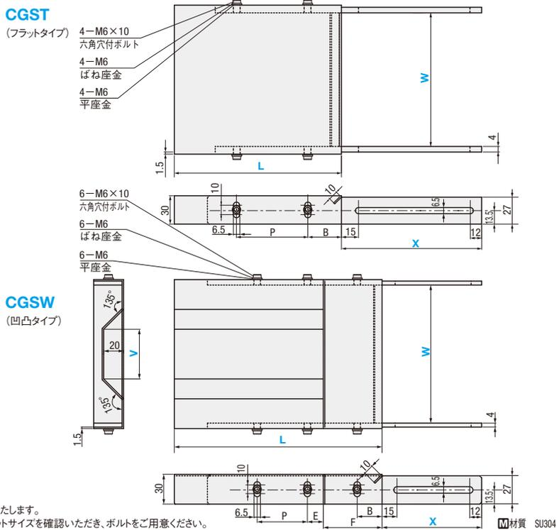
① L≥310の場合、追加加工YNS (溶接ナット+脚) を推奨いたします。
