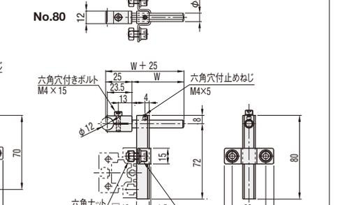
●No.55~80ではコンベヤ取付部のボルトサイズが異なります。ご使用のコンベヤに合わせてご選定ください。
