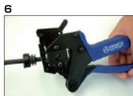
6 専用の圧着工具で圧着します。
