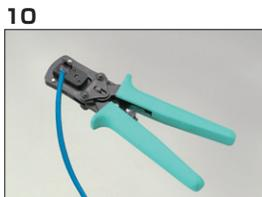
圧着工具で圧着します。全線奥まで挿入されていることを確認します。組立完了です。
