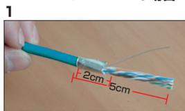
シースをストリッパで約5cmむきます。シールド(アルミ箔)をシース方向へ2cmおきかえます。
