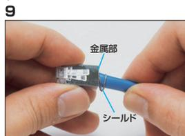
しっかりと先端部分までケーブルを挿入。合わせてシールド部分がプラグの金属部分に接触するよう差し込みます。
