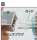
しっかりと先端部分までケーブルを挿入。合わせてシールド部分が、プラグの金属部に接触するよう差込みます。
