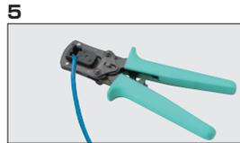
専用の圧着工具で圧着します。
