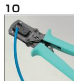
圧着工具で圧着します。全線奥まで挿入されていることを確認します。根元の不要なアルミホイルとドレインワイヤはさみなどで切り落とします。組立完了です。
