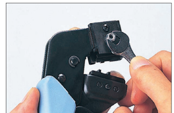
E1シリーズ用以外のダイスにはコンタクトの位置合せロケータが付いています。裏側に付属のナットで固定します。
