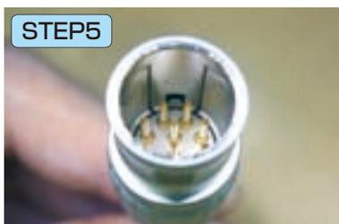
⑤ インサートキャリア先端の突起部分がアウターシェルに合うように注意し、アウターシェルを挿入する。
