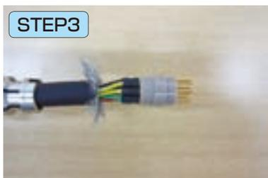
③ 各芯線に絶縁用の熱収縮チューブを通し、半田付けを行なう。半田付け後、熱収縮チューブを被せ、収縮させる。
