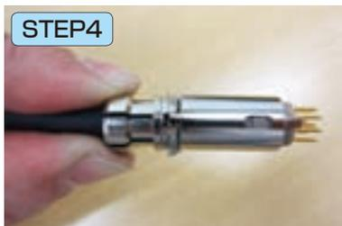
④ インシュレーターにインサートキャリアを取り付け、コレットを突き合わせ、はみ出したシールドを折り曲げ、切り揃える。
