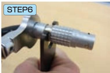
⑥ 2個のレンチを使用し、適正なトルク値(各商品ページ参照)でコレットナットを締め付ける。
