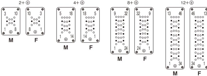
図中の●印はコンタクト装着、○印はコンタクト不使用(装着しないでください)
