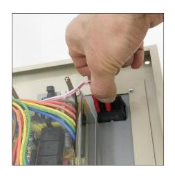
コネクタを外した後、パワースイッチを取り外します。 パワースイッチはツメでパネルに固定されています。
