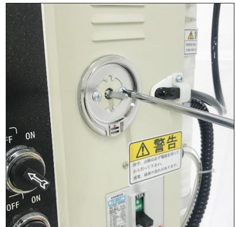
2本のネジを外すとコントロールボックス内の過熱防止ダイヤル EGO が外れます。
