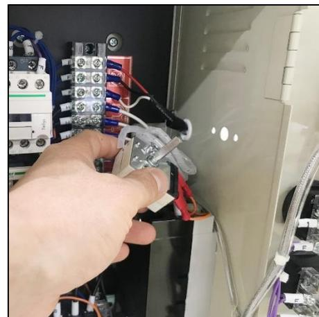
ドライヤー前面部の温度計の横にシリコンのコーキングでセンサー先端が固定されていますので、これを引き抜きます。
