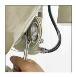
ネジ山で温度計は固定されています。 ある程度ゆるめると手で簡単に外すことができます。
