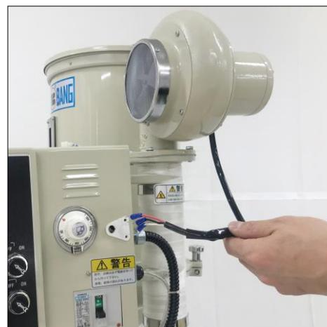
ブロワーモーターを固定しているボルトを外します。
