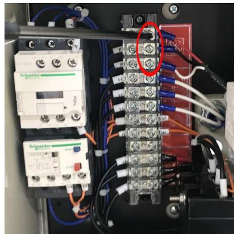
コントロールボックス側面のケーブル固定部品のネジを取り外します。
