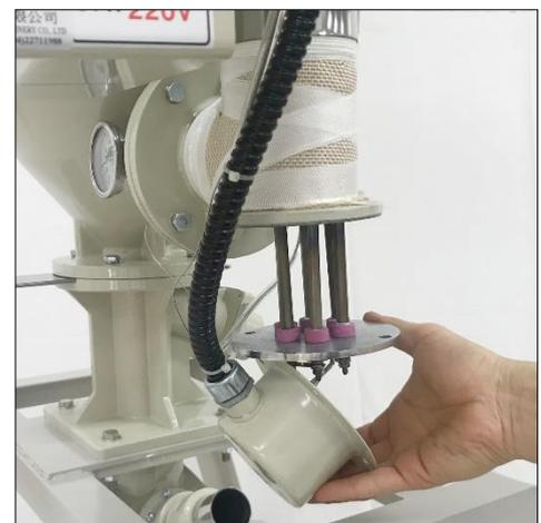
ヒーターの下側には、3箇所電線がナットで固定されています。
