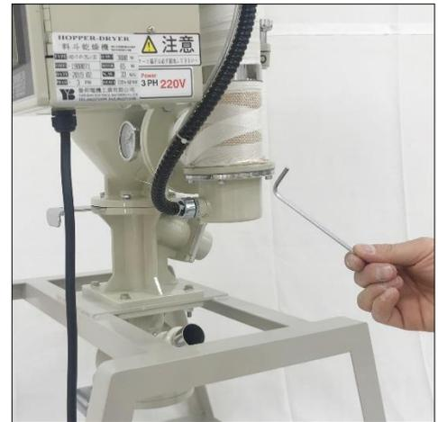
4本のボルトでヒーターとヒーターカバーの両方が固定されています。
