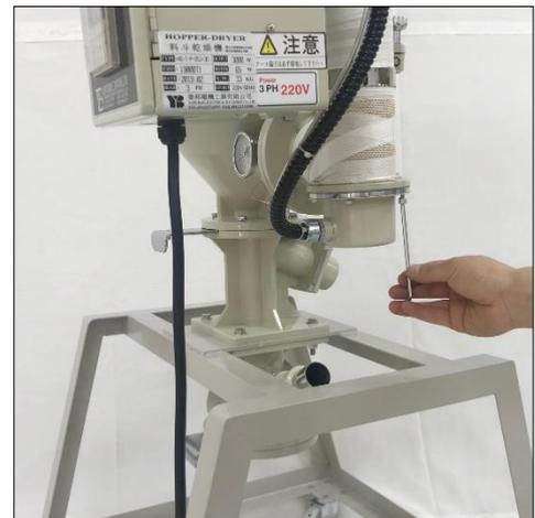
そのまま落としてしまうと接続された電線が傷つく場合がありますので、ゆっくりと下に下げていきます。
