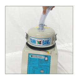
次に材料用ホースを接続します。 ホッパータンク部側面の接続口にホースを接続し ホースリングで固定します。
