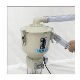
このホースのもう片方から材料を吸い上げます。同梱されているサクションノズル・架台下の吸引 ボックスノズルへ接続しホースリングで固定します。 これでホースの接続は完了です。
