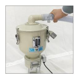
先ほど接続したホースのもう片方をローダーのフィルターカバー上の吸引エア接続口に接続しホースリングでホースを固定します。
